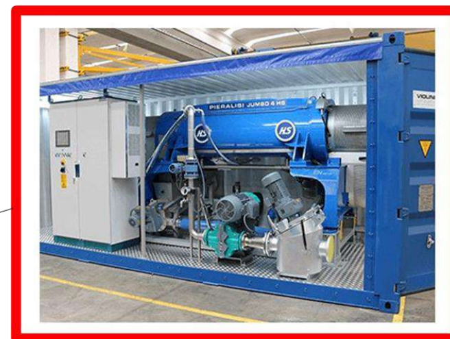
Sistema de Desaguamento Mecanizado (Container)
