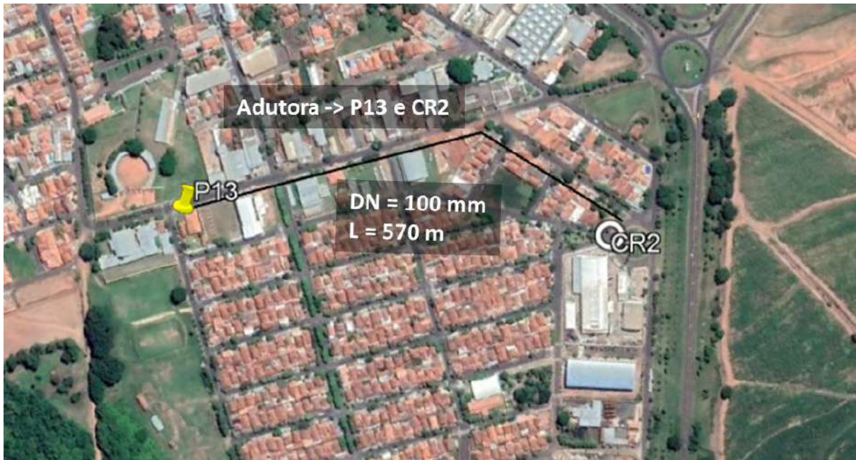
Figura 7.2 Traçado sugerido para adutora P13 – CR2
