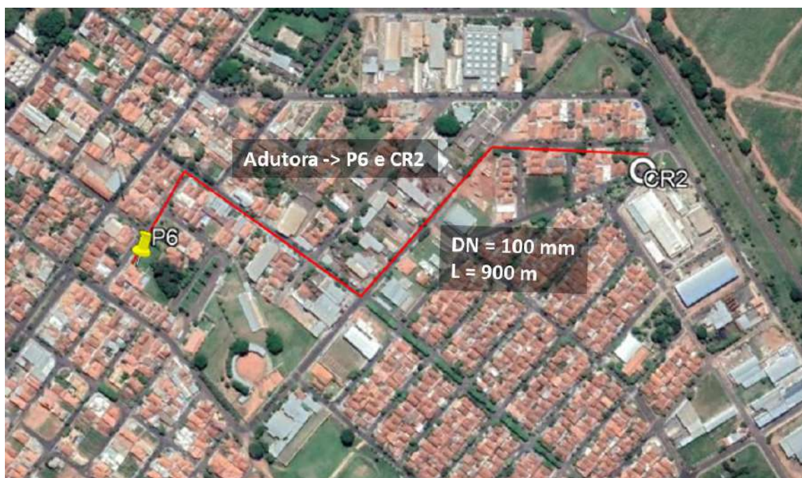
Figura 7.1 Traçado sugerido para adutora P6 – CR2
