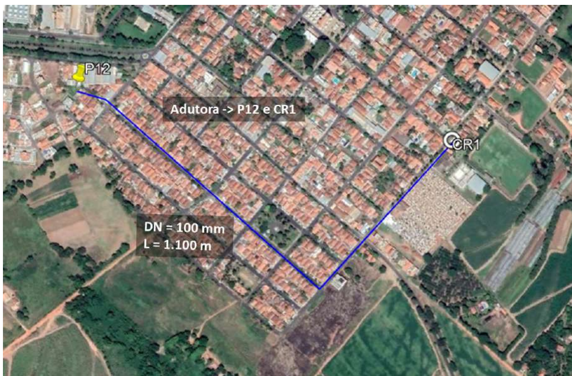
Figura 7.3 Traçado sugerido para adutora P12 – CR1
